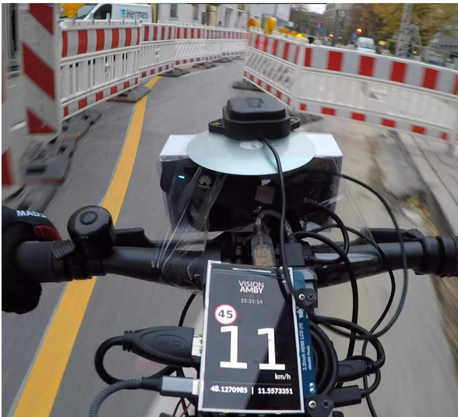
Versuchsaufbau der Testfahrten (Situation zeigt exemplarisch den Edge-Case ‚Temporäres Kraftfahrzeugfahrverbot‘)
