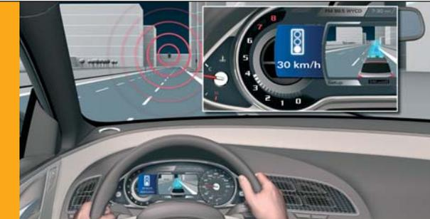
Im zweiten Teilprojekt wird an einigen Kreuzungen die Ampel-Fahrzeug-Kommunikation erprobt. Dabei werden zwischen Ampeln und Fahrzeugen Daten über WLAN ausgetauscht. Der Fahrer profitiert von diesem System, da er besser über die Ampelschaltung informiert wird. So kann ihm über geeignete Anzeigen im Fahrzeug die optimale Geschwindigkeit mitgeteilt werden, mit der er ohne Halt die nächste Kreuzung überqueren kann.
