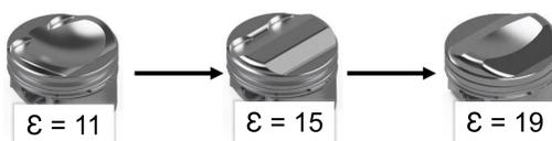
Erhöhung des Verdichtungsverhältnis mithilfe angepasster Kolben
