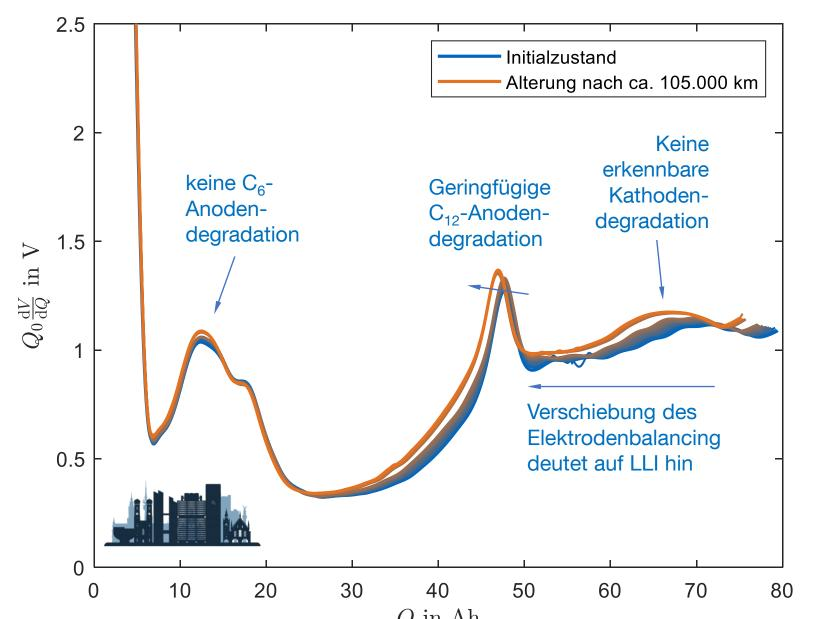
Verlust freier Ladungsträger (loss of lithium inventory, LLI) infolge von SEI-Bildung und -Wachstum dominiert das Degradationsverhalten.
