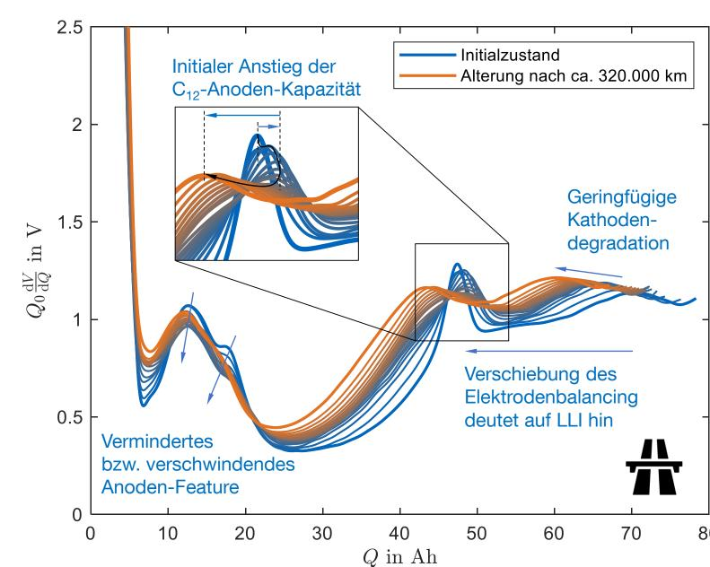
Komplexes und vielfältiges Degradationsverhalten aufgrund der hohen DODs und C-Raten: Anoden- und Kathodendegradation sowie Ladungsträgerverlust.
