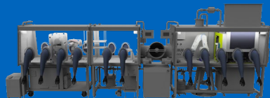
Abb. 8: Pilotlinie zur Assemblierung von Festkörperbatteriezellen in Inertgas-Atmosphäre
