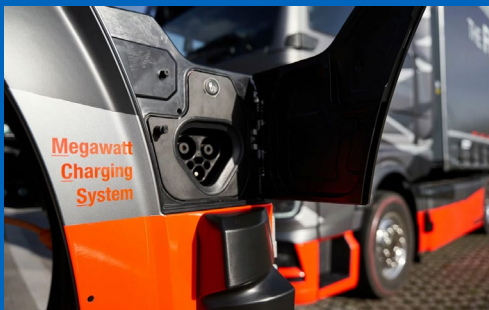
Abb. 23: Im Projekt NEFTON erproben wir erstmalig das Megawattladen für Nutzfahrzeuge
