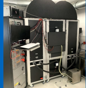
Abb. 3: Prüfstand für Lithium-Ionen-Zellen zur Erprobung verschiedener Kühlstrategien Steinhardt et al. 2021 Journal of Energy Storage
