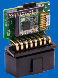
Abb. 22: In-house entwickelter Mobilitäts- und CAN-Datenlogger
