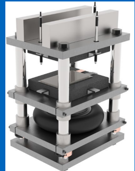
Abb. 4: Prüfstand zur mechanischen Verspannung von Lithium-Ionen-Zellen Aufschläger et al. 2023 Journal of Energy Storage
